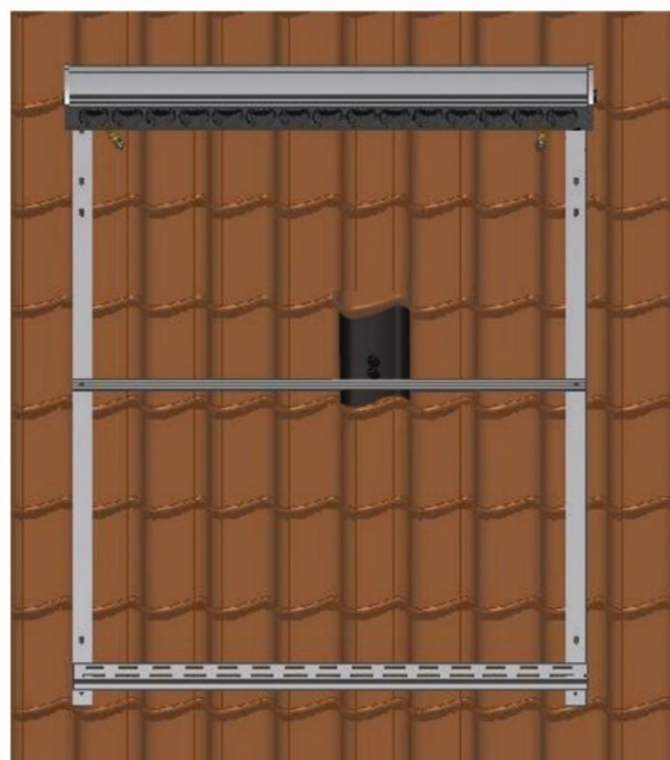
Figuur 14 - Dakdoorvoer geplaatst
