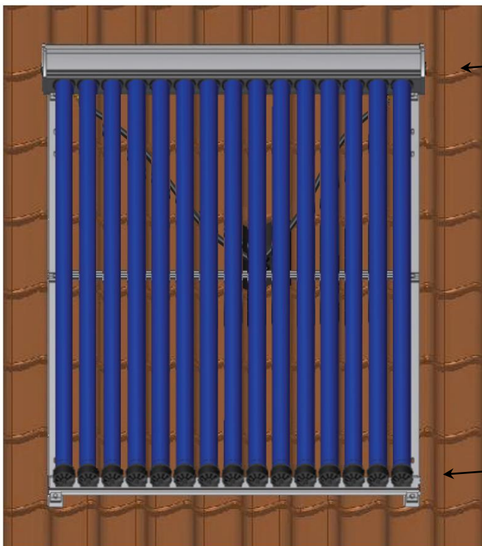
Figuur 25 - Collector geheel afgemonteerd.
