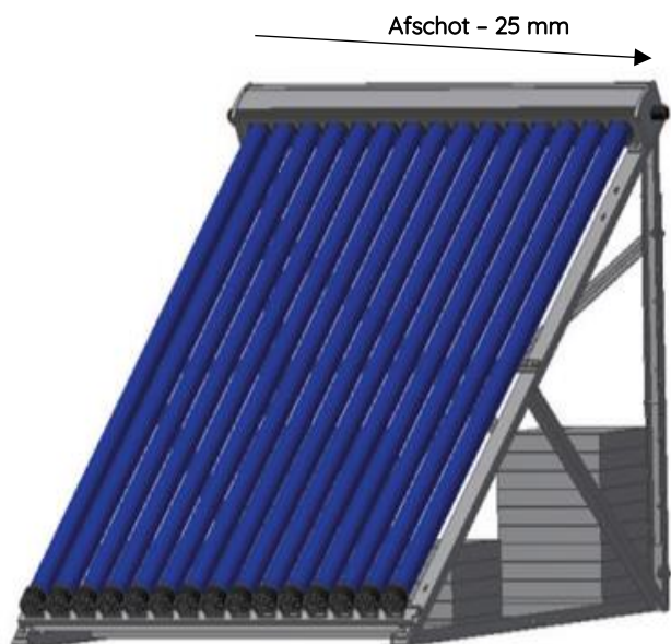
Figuur 29 – Gemonteerd dakframe plat dak met ballast
