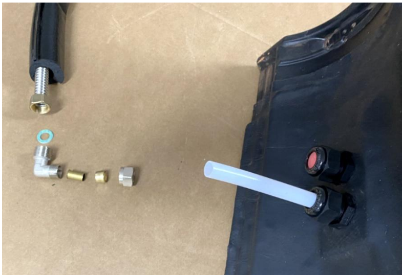
Montage RVS leiding aan Teflon leiding met haakse koppeling
